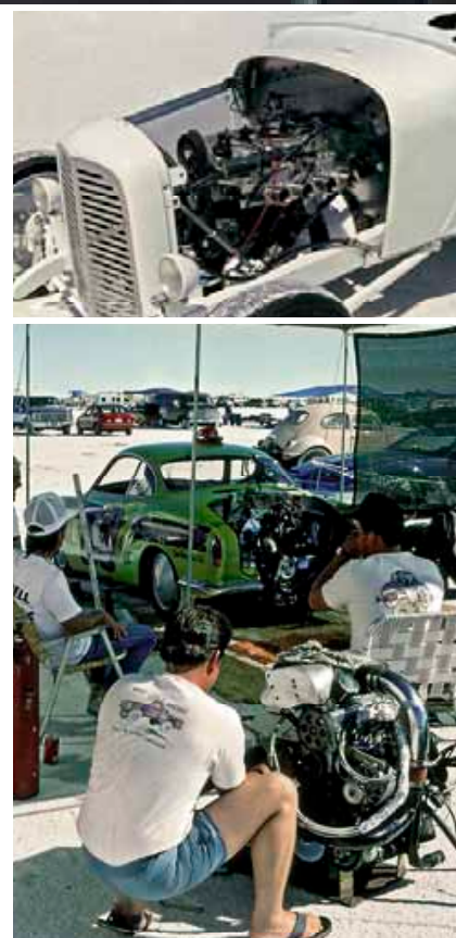
Oben: Im Rod arbeitete ein Golf-Block mit Passat-Kopf und Weber Doppelvergaser Unten: 1988 erreichte Larry Monreals Karmann mit 1,5-Liter Golf-Turbo 269 km/h
